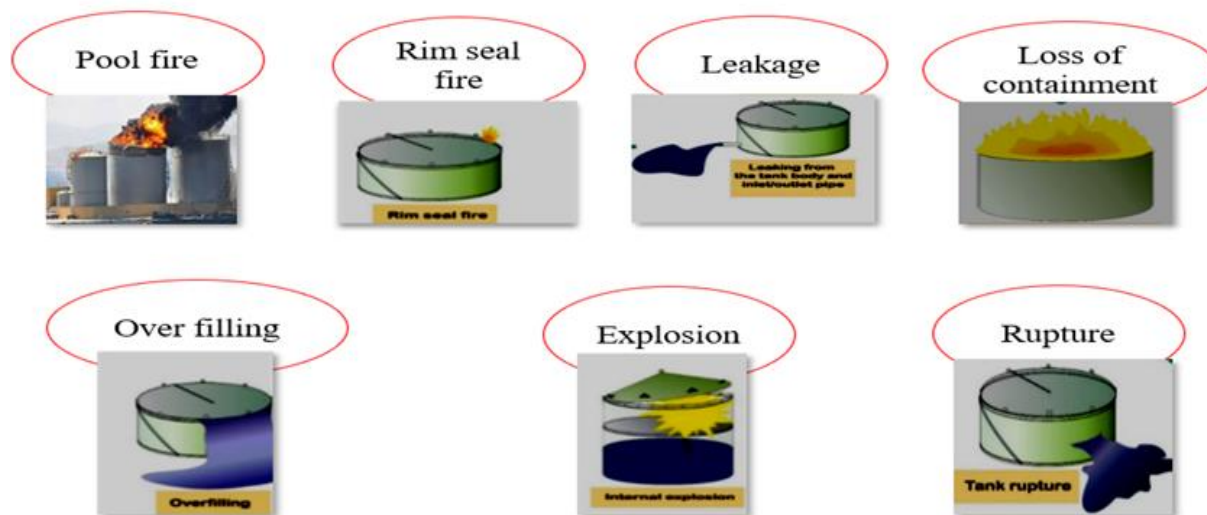
شکل ۲. سناریوهای منجر به حریق در مخازن ذخیره نفتی
